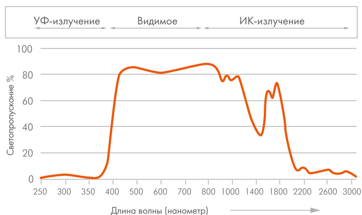
График 01: Спектр пропускания света листом LEXAN THERMOCLEAR
